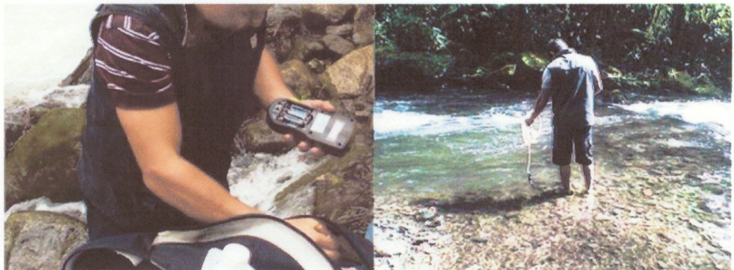
Fig. 3.- Preparación y utilización del multiparámetro HQ40d.
