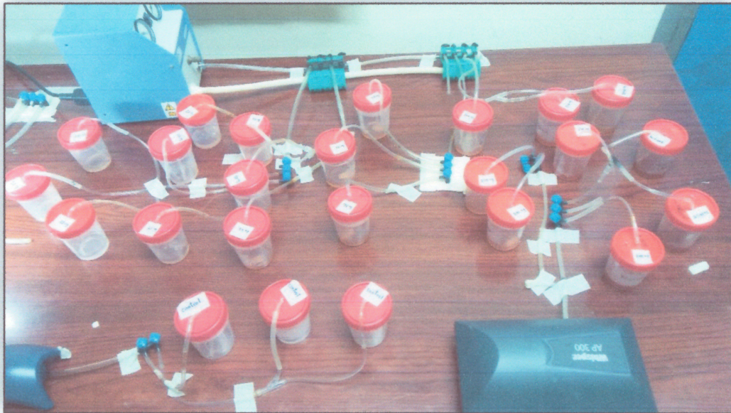
Figura 13. Sistema de aireación para el ensayo de toxicidad aguda con nauplios de Artemia Salina . Un grupo control y 7 concentraciones con 3 réplicas cada uno.
