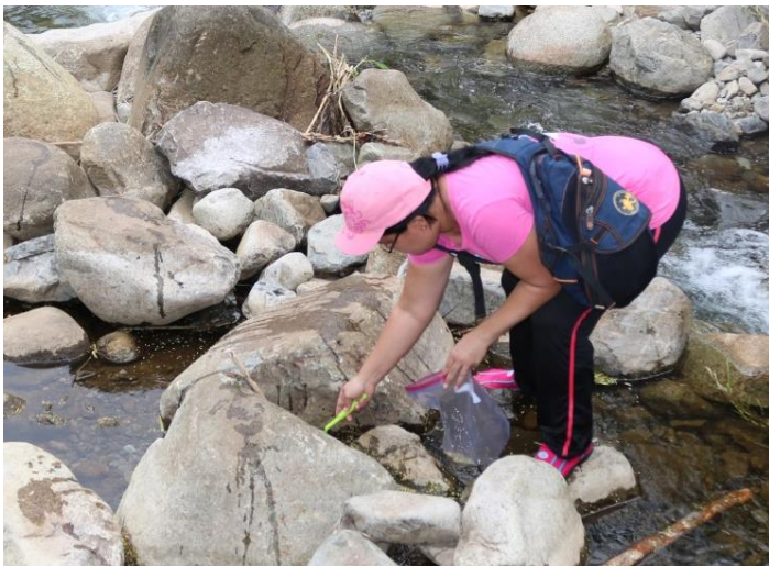
Fig.75. Toma de la muestra en bolsa de plástico con agua destilada.
