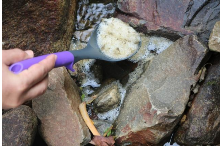
Fig.74. Toma de muestras de espuma con cuchara estéril.
