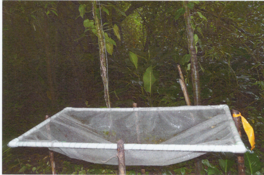
Figura 6. Canasta recolectora de hojarasca instalada en las parcela A y B
