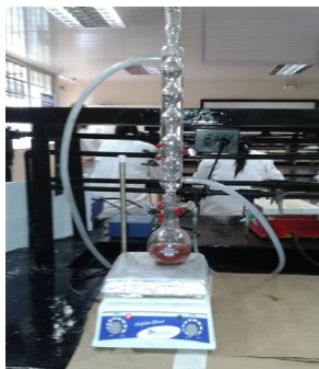
Figura 2. Extracción de la Corteza de Byrsonima crassifolia mediante reflujo.
