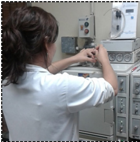
B. Inyección de muestras en el cromatógrafo de gas Shimadzu modelo GC 14B.
