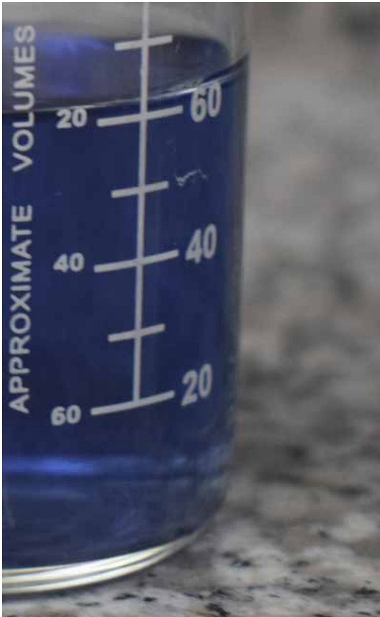
Complejo de azul de molibdeno usado para la determinación de fosfatos por método colorimétrico.
