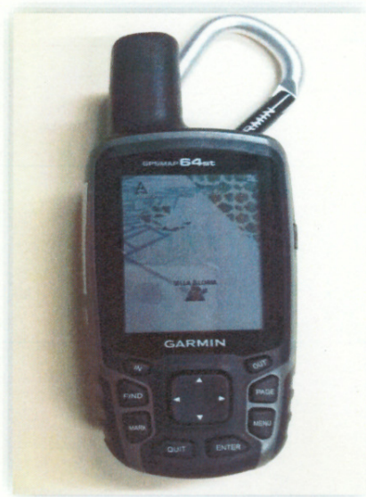
FIGURA 6. GPS marca Garmin modelo-GPSMAP 64st utilizado en las inspecciones de campo para georreferenciar la ubicación de los proyectos.
