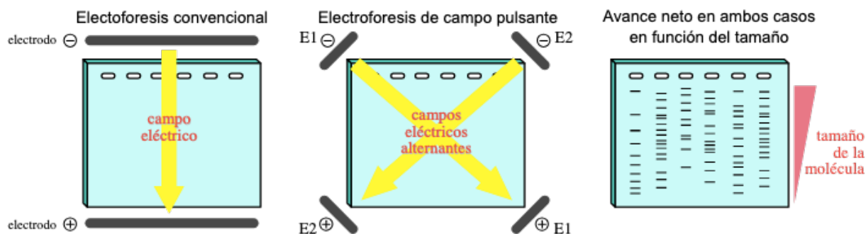
Figura 7. Diferencias entre una electroforesis convencional y una de campo pulsado
