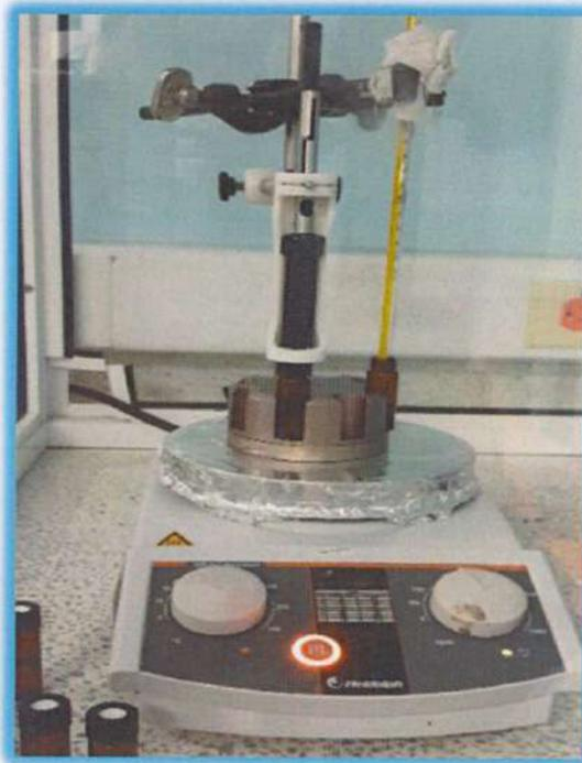
**Figura 9.** Montaje de un SPME
