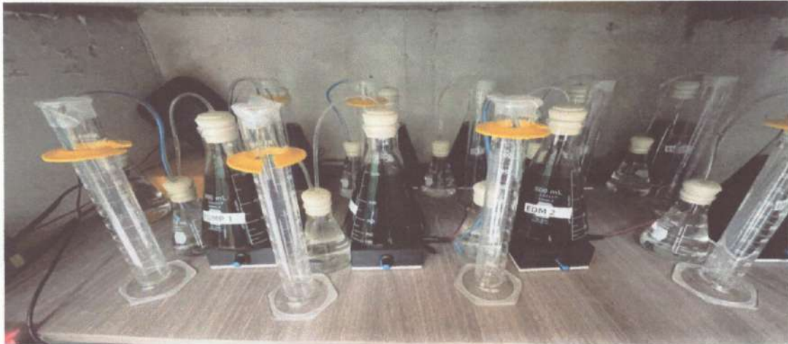
Figura 27. Sistema de dilución de gases utilizado para construcción de las curvas de calibración de \text{CO}_2 y \text{CH}_4 .
