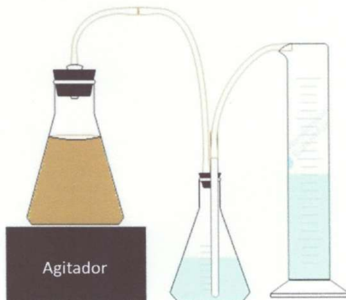
Figura 7. Diagrama del digestor anaerobio y sistema de recolección de gases.
