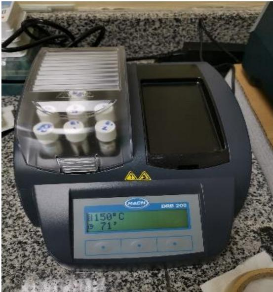
**Figura A22.** Muestras de AR en el termostato marca HACH modelo DRB 200 para su posterior análisis en el espectrofotómetro
