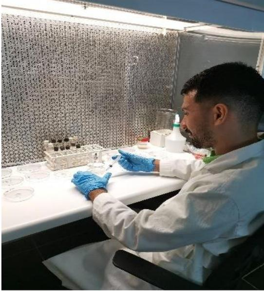
**Figura A16.** Preparación de las muestras de ARs mediante la técnica de vertido en placa y diluciones seriadas en factor 1:10 para su posterior recuento bacteriano
