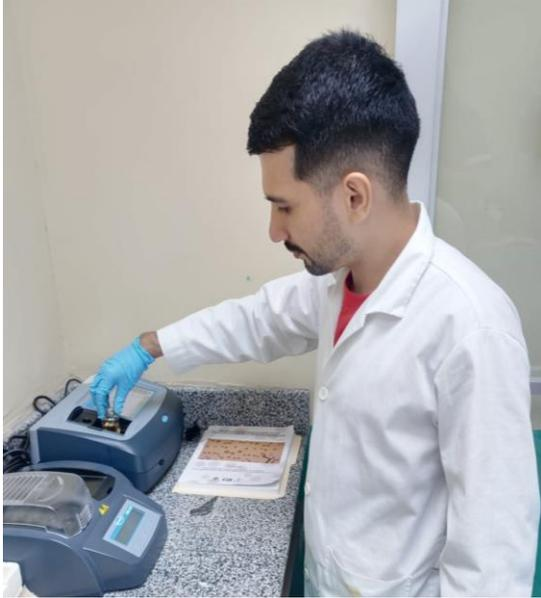
**Figura A20.** Análisis de nitratos empleando sobre NitraVer 8039 HR y el espectrofotómetro HACH DR 3900
