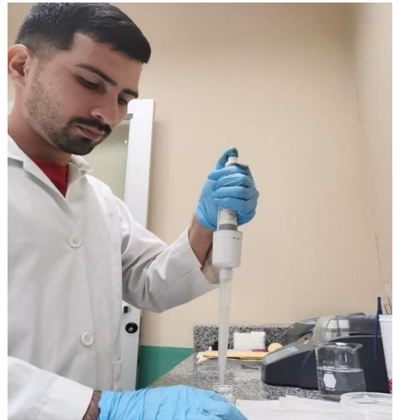
**Figura A19.** Preparación de las muestras de ARs para su posterior análisis de nitratos empleando sobre NitraVer 8039 HR y el espectrofotometro HACH DR 3900
