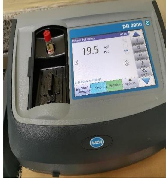
**Figura A21.** Análisis de ortofosfatos empleando viales TNT 846 y el espectrofotómetro HACH DR 3900
