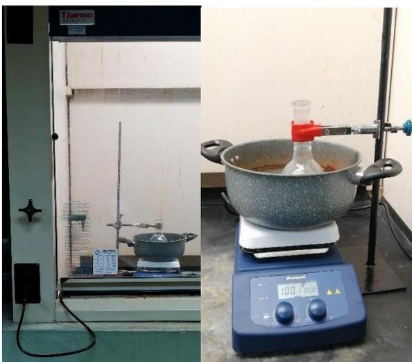
**Figura n°36.** Baño María, evaporación del disolvente (éter etílico)
