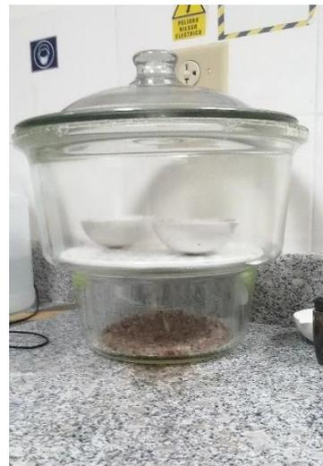
**Figura n°31.** Enfriar muestras en el desecador
