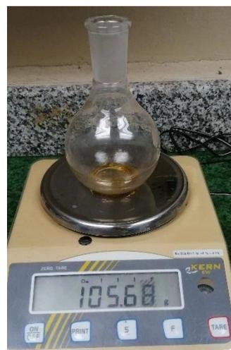
**Figura n°37.** Pesaje del balón con la muestra extraída
