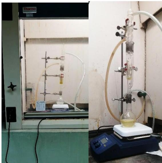
**Figura n°35.** Montaje del sistema de extracción soxhlet
