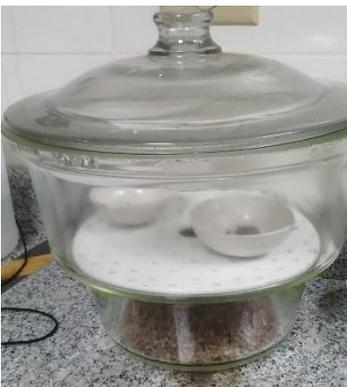
**Figura n°41.** Enfriamiento de muestra en el desecador
