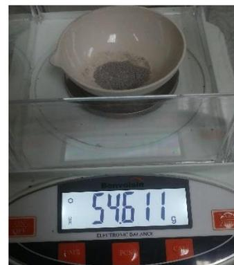
**Figura n°42.** Peso del crisol más muestra incinerada
