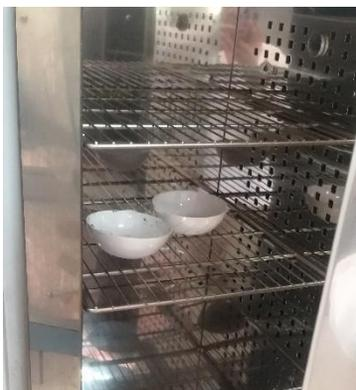
**Figura n°46.** Secado en horno
