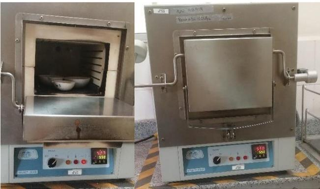
**Figura n°40.** Incineración de muestras en la mufla
