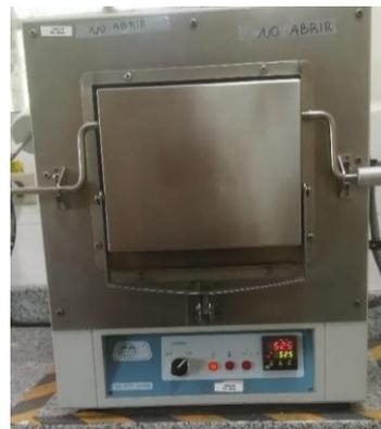
**Figura n°47.** Reducción de la muestra a cenizas
