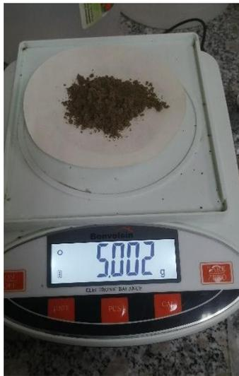
**Figura n°33.** Pesaje de muestra desecada
