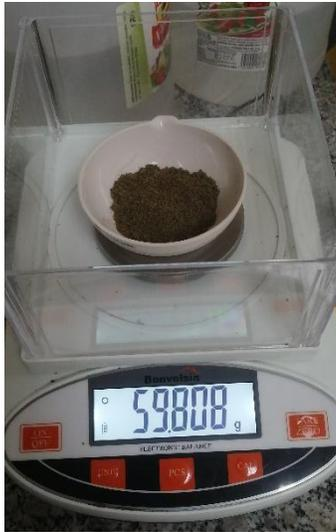
**Figura n°32.** Peso del crisol más muestra desecada
