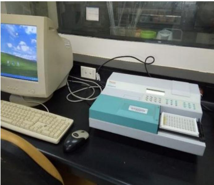
**FIGURA 14. LECTOR DE MICROPLACAS ELISA UTILIZADO EN LOS LABORATORIOS DEL INTA**
