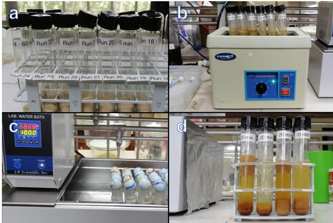
*Nota: a) preparación de mezclas, b) tratamiento en baño sónico, c) tratamiento en baño térmico, y d) tubos de reacción antes del filtrado.*
