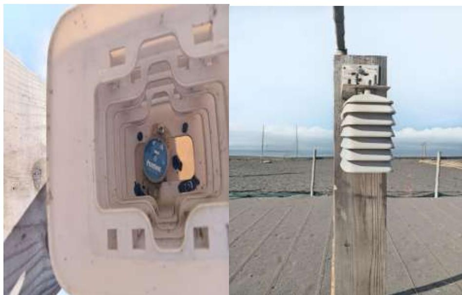
**Figura 6.** Termómetro que mide la temperatura ambiental con un sensor Hobo-pendant (MX2201). Fuente: elaboración propia.
