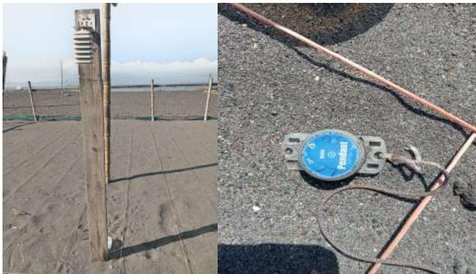
**Figura 7.** Termómetro que mide la temperatura dentro de la arena con un sensor Hobo-pendant (MX2201). Fuente: elaboración propia.
