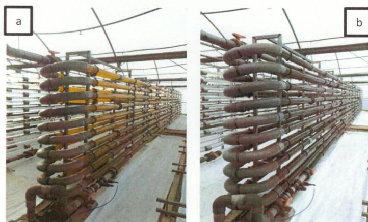
**Figura 2.** Crecimiento de T-Iso en un fotobiorreactor tubular, (a) Inicio del experimento, (b) fin del ensayo.
