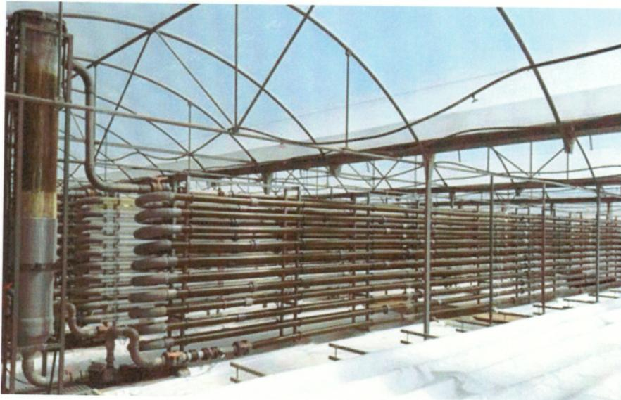
Figura 24. Fotobiorreactor tubular (PBR-T) empleado para esta investigación.
