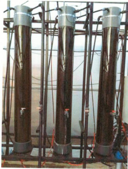
**Figura 26.** Fotobiorreactor de columnas de burbujeo (PBR-BC) empleados para esta investigación.
