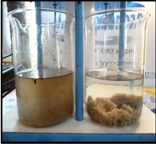
Figura 3: Proceso de Floculación Fuente: http://www.ayre.cl/tratamiento.html
