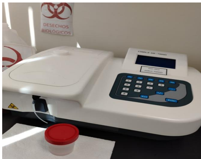
Ilustración 8. Rotulación de las muestras y determinación del perfil lipídico por espectrofotometría.
