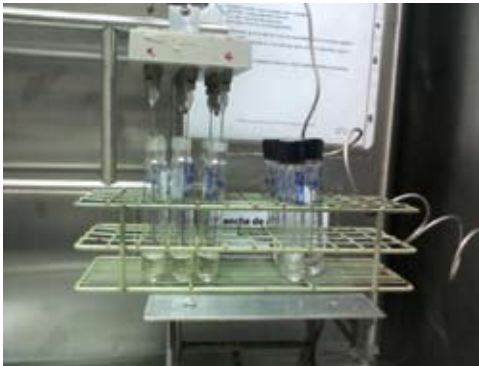
Fig. 2 Evaporación de cloroformo en la extracción de lípidos totales, utilizando nitrógeno gaseoso. Centro de Investigaciones Biológicas del Noroeste, CIBNOR.
